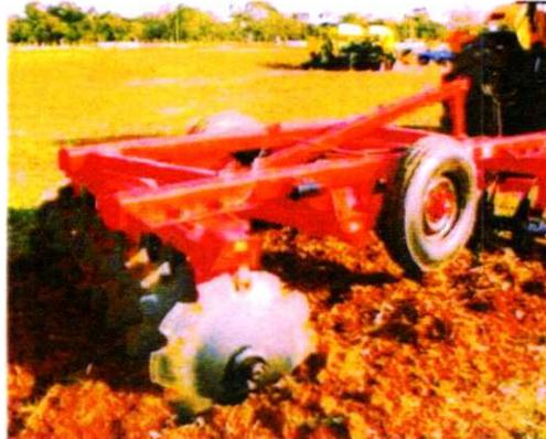
Informações Gerais: Equipamento para gradeamento ou aragem de solo, comumente utilizado para homogeneização de umidade e destorroamento do solo em obras de terraplanagem, também utilizado no preparo do solo para culturas agrícolas. Acionada por controle remoto.
